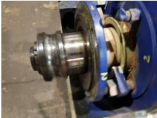
Eje con pista interior del rodamiento roto
