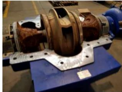
Estado de la bomba al abrir la voluta
