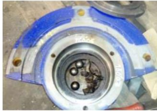
Restos de la jaula del rodamiento en el soporte.
