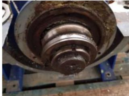
Eje con pista interior del rodamiento roto
