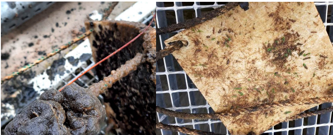
Figura 3. Briozoos adheridos a la cuerda que sostiene las placas de muestreo, y briozoos adheridos a la placa de PRFV.
