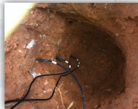
SONDAS HUMEDAD DE SUELO
